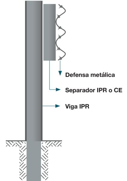
NORMAS DE FABRICACIÓN: ASTM A572-50 ASTM A992 ASTM A123 / A123M - 17
